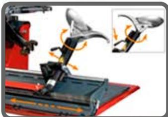
Movimientos del brazo de desmontaje: semiautomáticos por DIDO 56A (elevación y rotación manual, desplazamiento lateral hidráulico) y manual por DIDO 56 (elevación, rotación y desplazamiento lateral manuales).
