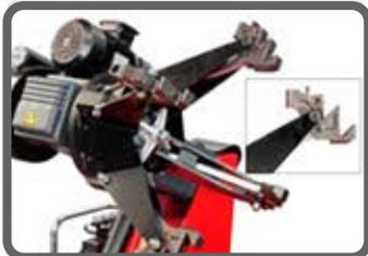
Autocentrante universal hidráulico para bloquear las llantas con capacidad de bloqueo directo de 14" hasta 42" (hasta 56" con extensiones - opcional). 5 puntos de sujeción en la mordaza. Dos velocidades para cada sentido de rotación. Bloqueo diámetro mínimo: 115 mm.
